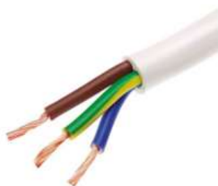
Figur 15: Kabel med tre ledere: en fase (brun), en nulforbindelse (blå) og en jord (grøn/gul)
